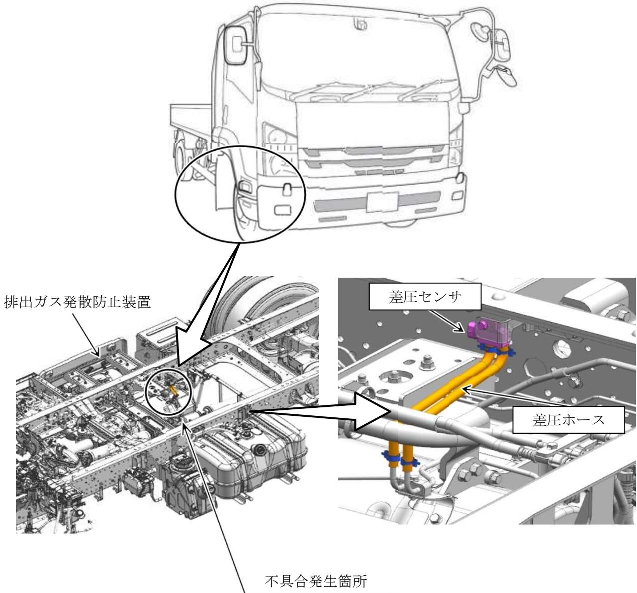
トラックの排出ガス発散防止装置において、差圧センサに組み付ける差圧ホースの材質が不適切なため、当該ホースから放出されるヨウ素により差圧センサの回路が腐食して断線し、エンジン警告灯が点灯するおそれがある。
